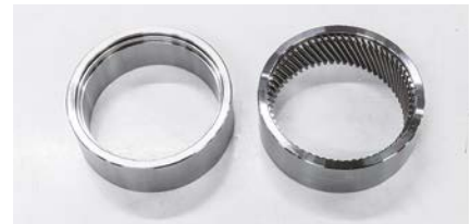
[Solda] Parçanın broşlanmadan önceki hali [Sağda] Parçanın broşlanmadan sonraki hali
